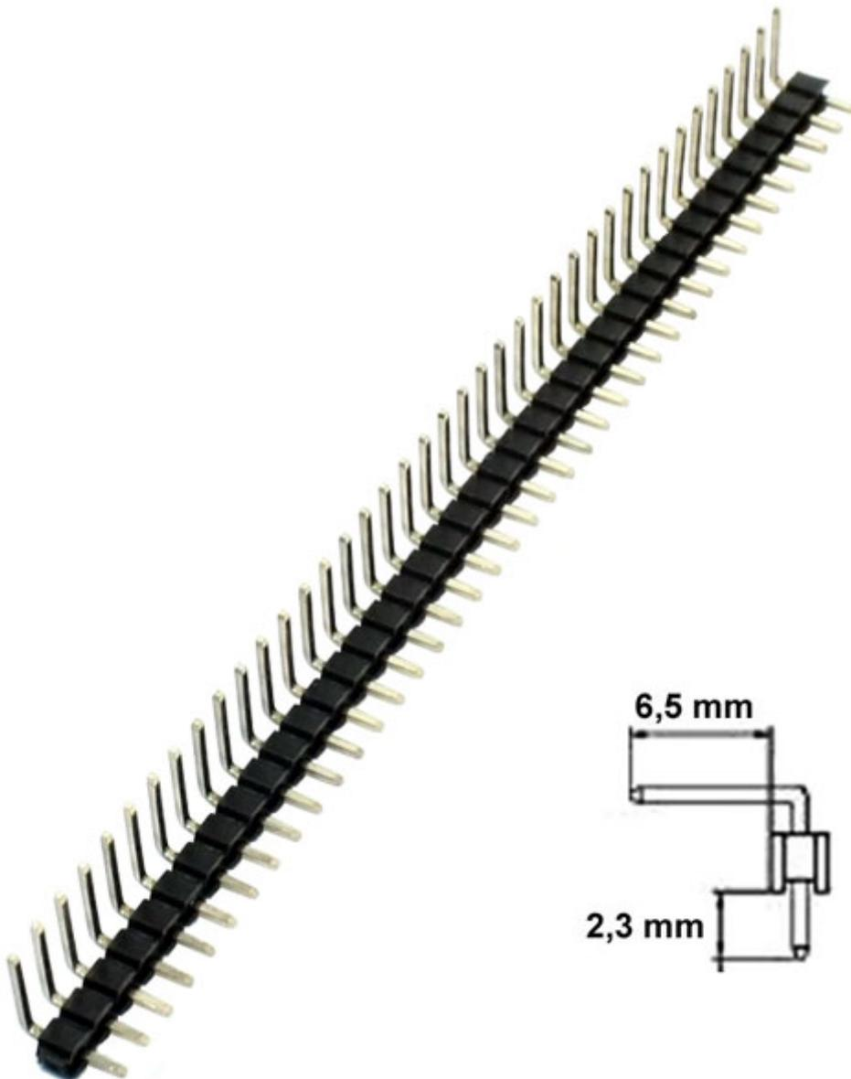
Connettore strip maschio da circuito stampato con 40 pin a 90° e passo 2.54 mm. Possibilità di dividere il connettore a piacimento. Materiale contatti: bronzo fosforoso.
