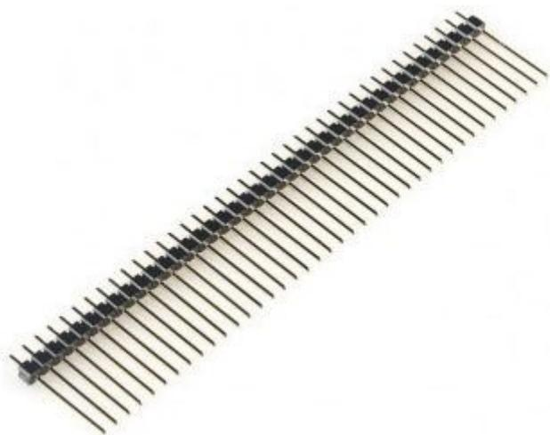
Connettore maschio da c.s. con 40 pin lunghi 13 mm e passo 2.54 mm. Possibilità di dividere il connettore a piacimento. Materiale contatti: bronzo fosforoso.
