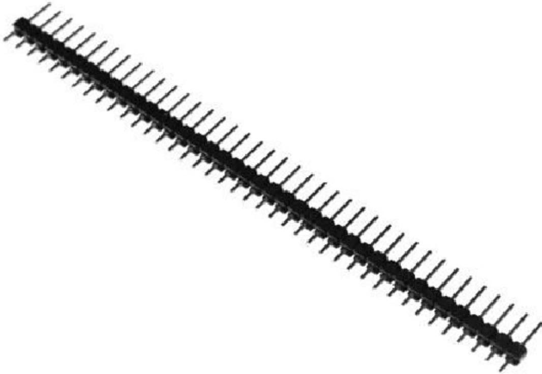
Connettore maschio da c.s. con 40 pin passo 2.54 mm. Possibilità di dividere il connettore a piacimento. Materiale contatti: bronzo fosforoso.
