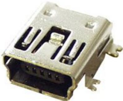
Connettore USB femmina tipo "miniB" a 5 pin. Montaggio SMD. Comunemente utilizzato nei lettori MP3, hub USB e altri dispositivi con dimensioni molto ridotte. Dimensioni: 9,2 x 7,7 x 4 mm.
