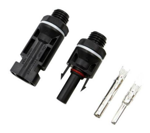
Adatti per cavi con sezione 4 mm² e 6 mm², questa coppia di connettori compatibili MC4 maschio / femmina, sono indicati per collegare uno o più pannelli solari e ottenere connessioni sicure e veloci. Sistema di bloccaggio: Snap in, tensione nominale: 1000 VDC, corrente nominale: 30 A, grado di protezione: IP67, classe di sicurezza: II, materiale contatti: rame stagnato, resistenza contatti: temperatura di lavoro: da -40°C a +90°C
