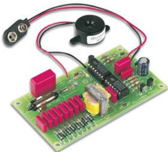
Contatore Geiger-Muller in grado di fornire una misura acustica dei livelli di radiazione. La sensibilità è massima per i raggi gamma e per i raggi beta ad alto contenuto di energia. Molto compatto e può essere alloggiato all'interno di un piccolo contenitore (8220-G416), unitamente alla batteria da 9V.
