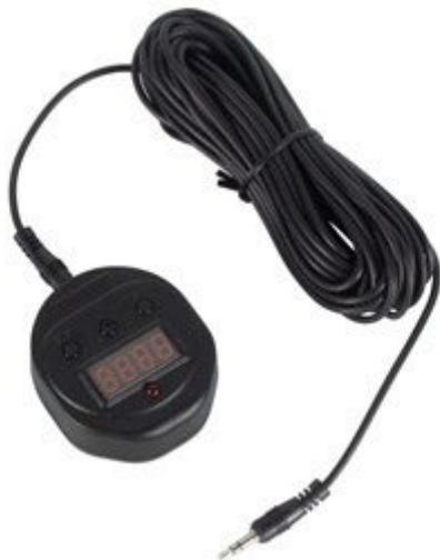
Contatore a 4 cifre da collegare alla barriera ad infrarossi PEM7D in grado di indicare quante volte la barriera è stata interrotta dal passaggio di una persona. Sul pannello frontale sono presenti tre pulsanti a cui corrispondono le seguenti funzioni: reset; incrementa di una unità il conteggio; decrementa di 1 unità il conteggio. Il dispositivo viene fornito con 10 metri di cavo e gli accessori per il fissaggio a muro.
