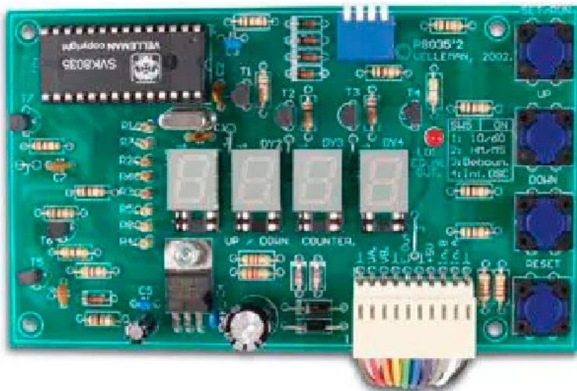
Particolarmente indicato per il conteggio di persone, di oggetti e parti meccaniche e per visualizzare il punteggio nel corso di attività sportive. Permette il conteggio sia per valori a salire che a scendere, in maniera automatica (tramite impulsi esterni), oppure manualmente, mediante i pulsanti presenti sulla scheda. L'oscillatore interno permette la misurazione di intervalli di tempo. L'uscita a relè del circuito può essere attivata quando il conteggio raggiunge un valore prefissato.
