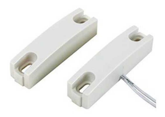
Contatto magnetico in miniatura. Ideale per essere impiegato in impianti d'antifurto, permettendo di controllare lo stato di porte e finestre. Quando i due elementi sono in prossimità il contatto è chiuso, allontanandoli si apre.
