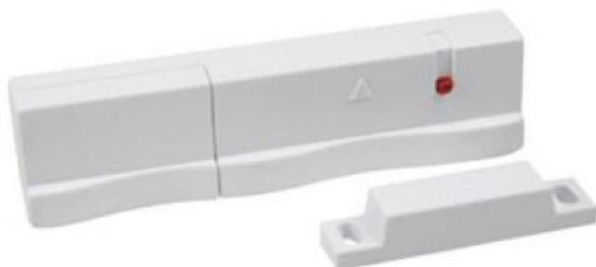
Contatto magnetico wireless per centrale antifurto FR522. Codice di identificazione programmabile tramite dipswitch (256 codici), portata trasmissione: 50 metri senza ostacoli, alimentazione: 1 batteria alcalina 12V tipo A23 (inclusa), dimensioni (mm): 23x113x17.
