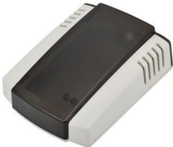
Contenitore realizzato in ABS composto da una parte superiore, dotata di pannello fumè (102x48) con predisposizione per l'inserimento di due LED da 3 mm, e una parte inferiore dotata di fori di chiusura e fori per fissaggio a parete. Dispone di angoli arrotondati, dimensioni esterne (mm): 133 (lunghezza) x 102 (larghezza) x 42 (altezza) mm, dimensioni interne (mm): 114 (lunghezza) x 92 (larghezza) x 24 (altezza massima - 16 altezza minima). Colore: bianco e nero.
