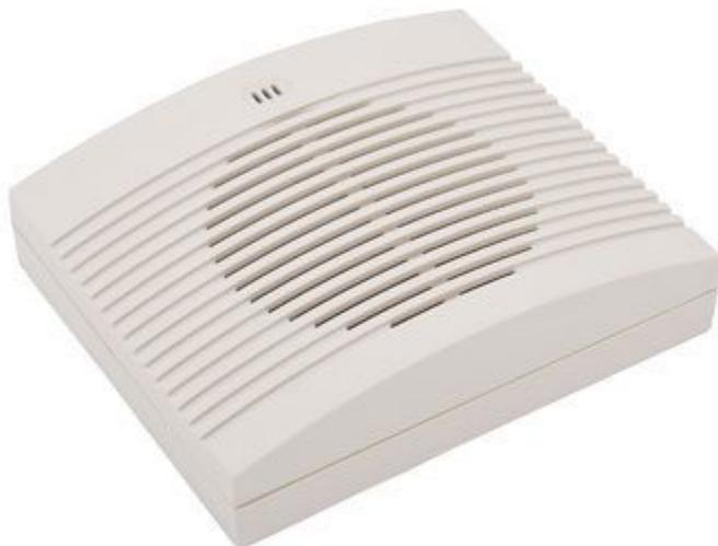
Contenitore realizzato in ABS dotato di angoli arrotondati, dimensioni esterne (mm): 90 x 76 x 25 (altezza) mm, dimensioni interne (mm): 61,80 x 86,55 x 14 (altezza). Colore: avorio. Al suo interno può essere inserito un piccolo altoparlante con diametro max 12 mm e una capsula microfonica preamplificata.
