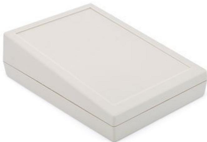
Contenitore a leggio realizzato in materiale ABS. Ideale per strumentazione ed apparecchiature per telecomunicazioni, sia per dispositivi portatili che da laboratorio. Ottimo rapporto qualità/prezzo. Dimensioni esterne: 134 x 189 x 32/55 mm, dimensioni interne: 123,60 x181 x 25/47 mm. Colore: grigio.
