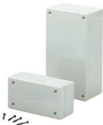
Contenitore realizzato in materiale ABS antiurto. Dispone di guide per l'alloggiamento di schede elettroniche. Le guide sono distanziate tra loro di 20 mm e accettano schede con uno spessore massimo di 1,6 mm. Ideale per strumentazione ed apparecchiature per telecomunicazioni, sia per dispositivi portatili che da laboratorio. Ottimo rapporto qualità/prezzo. Dimensioni esterne: 95 x 48 x 38 mm. Dimensioni interne: 86,73 x 39,55 x 23,27 mm. Colore: grigio chiaro.
