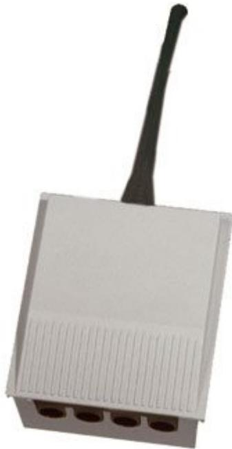
Strutturato appositamente per contenere ricevitori e trasmettitori da collocare in ambienti esterni; grazie alla sua chiusura ermetica, protegge dall'umidità e dalle intemperie i circuiti in esso contenuti. Il contenitore dispone di un'antenna accordata a 433 MHz. L'uscita dei cavi è agevolata da quattro passacavi in gomma. Dimensioni esterne (mm): 95x85x50, dimensioni interne (mm): 70x80x37.
