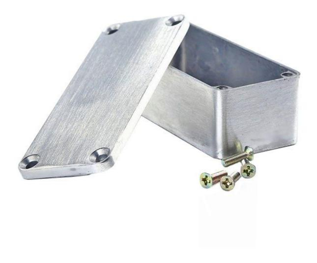
Contenitore in alluminio leggero, resistente alla corrosione, con spessore 2 mm, angoli arrotondati e viti in acciaio inox. Ideale per apparecchiature elettroniche, effetti per strumenti musicali, ecc. Dimensioni esterne (mm): 100x50x26, dimensioni interne (mm): 96x46x25, peso: 112 grammi.
