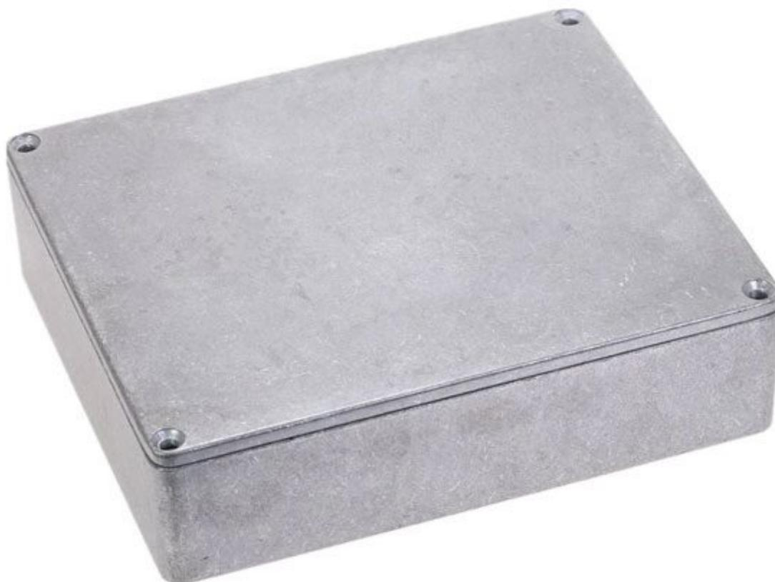
Contenitore in alluminio leggero, resistente alla corrosione, con spessore 2 mm, angoli arrotondati e viti in acciaio inox. Ideale per apparecchiature elettroniche, effetti per strumenti musicali, ecc. Dimensioni esterne (mm): 145x121x39,5, dimensioni interne (mm): 141x117x33, peso: 334 grammi.
