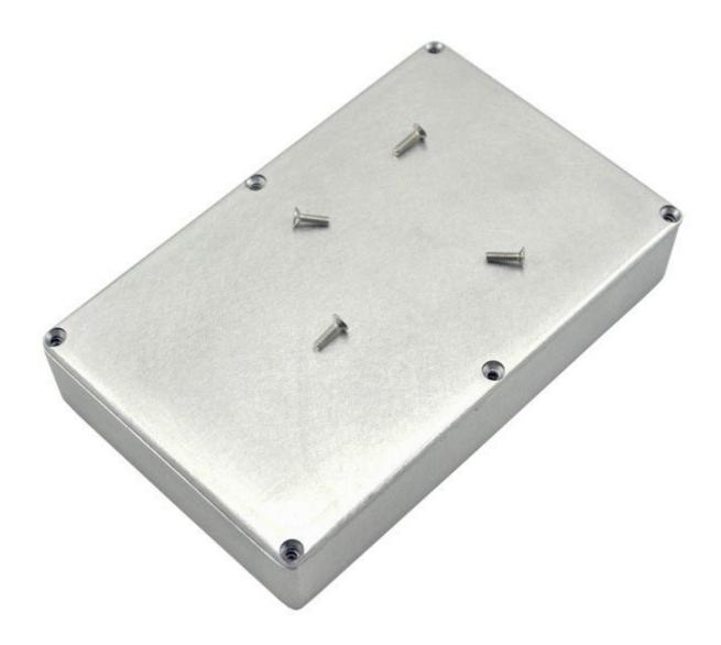
Contenitore in alluminio leggero, resistente alla corrosione, con spessore 2 mm, angoli arrotondati e viti in acciaio inox. Ideale per apparecchiature elettroniche, effetti per strumenti musicali, ecc. Dimensioni esterne (mm): 188x120x37, dimensioni interne (mm): 184x116x30, peso: 498 grammi.
