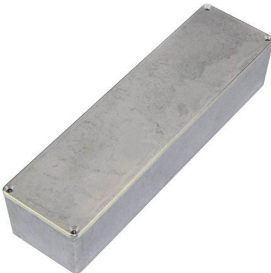
Contenitore in alluminio leggero, resistente alla corrosione, con spessore 2 mm, angoli arrotondati e viti in acciaio inox. Ideale per apparecchiature elettroniche, effetti per strumenti musicali, ecc. Dimensioni esterne (mm): 254x71x52,5, dimensioni interne (mm): **96x46x192,5**, peso: **112** grammi.
