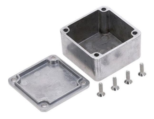
Contenitore in alluminio leggero, resistente alla corrosione, con spessore 2 mm, angoli arrotondati e viti in acciaio inox. Ideale per apparecchiature elettroniche, effetti per strumenti musicali, ecc. Dimensioni esterne (mm): 50,5x50x31, dimensioni interne (mm): 46x46x25, peso: 67,5 grammi.
