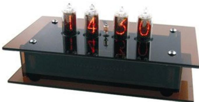
Contenitore perforato in plexiglass per "NIXIE CLOCK". Dimensioni: 130 x 75 x 35 mm.
