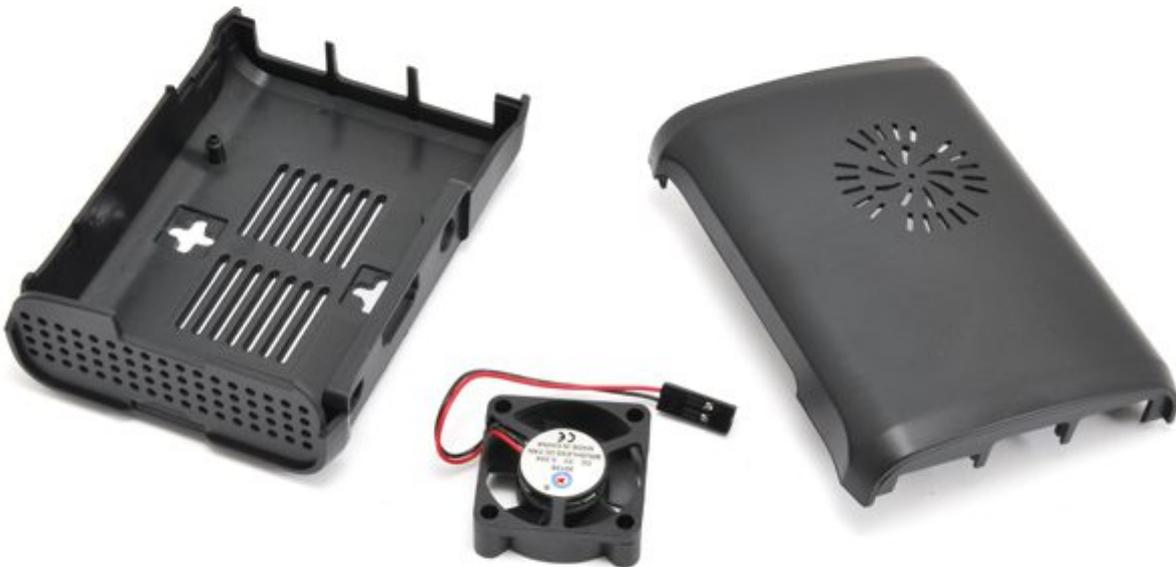
Contenitore in ABS di colore nero appositamente realizzato e forato per ospitare il prodotto Raspberry PI 3B / 3B+ / 2B / B+. La confezione comprende anche una ventola di raffreddamento a 5 V. Il contenitore si assembla semplicemente incastrando la parte superiore e inferiore. Dimensioni esterne (mm): 93 (lunghezza) x 68 (larghezza) x 34 (altezza) mm, dimensioni interne (mm): 86 (lunghezza) x 58 (larghezza) x 26 (altezza), peso: 46,5 grammi. **N.B.** il prodotto Raspberry PI non è compreso.
