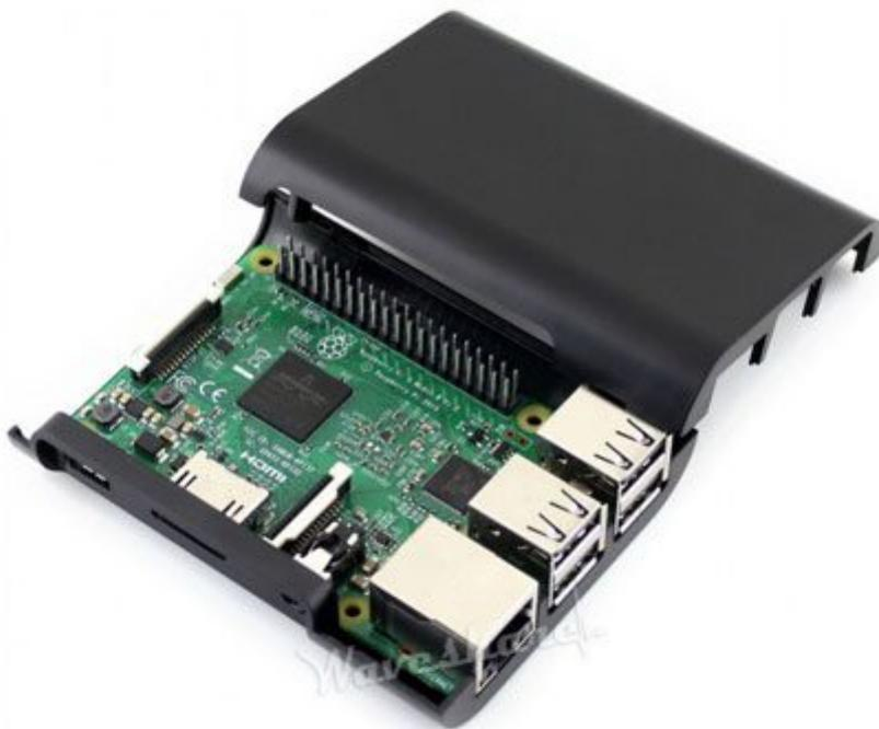
Contenitore plastico di colore nero appositamente realizzato e forato per ospitare il prodotto [Raspberry Pi](#) 2 modello B, Raspberry Pi modello B+ e Raspberry Pi 3. Si assembla semplicemente incastrando le due metà. Dimensioni esterne (mm): 92 (lunghezza) x 62,50 (larghezza) x 26,70 (altezza) mm, dimensioni interne (mm): 86 (lunghezza) x 57 (larghezza) x 26 (altezza). Comprende
