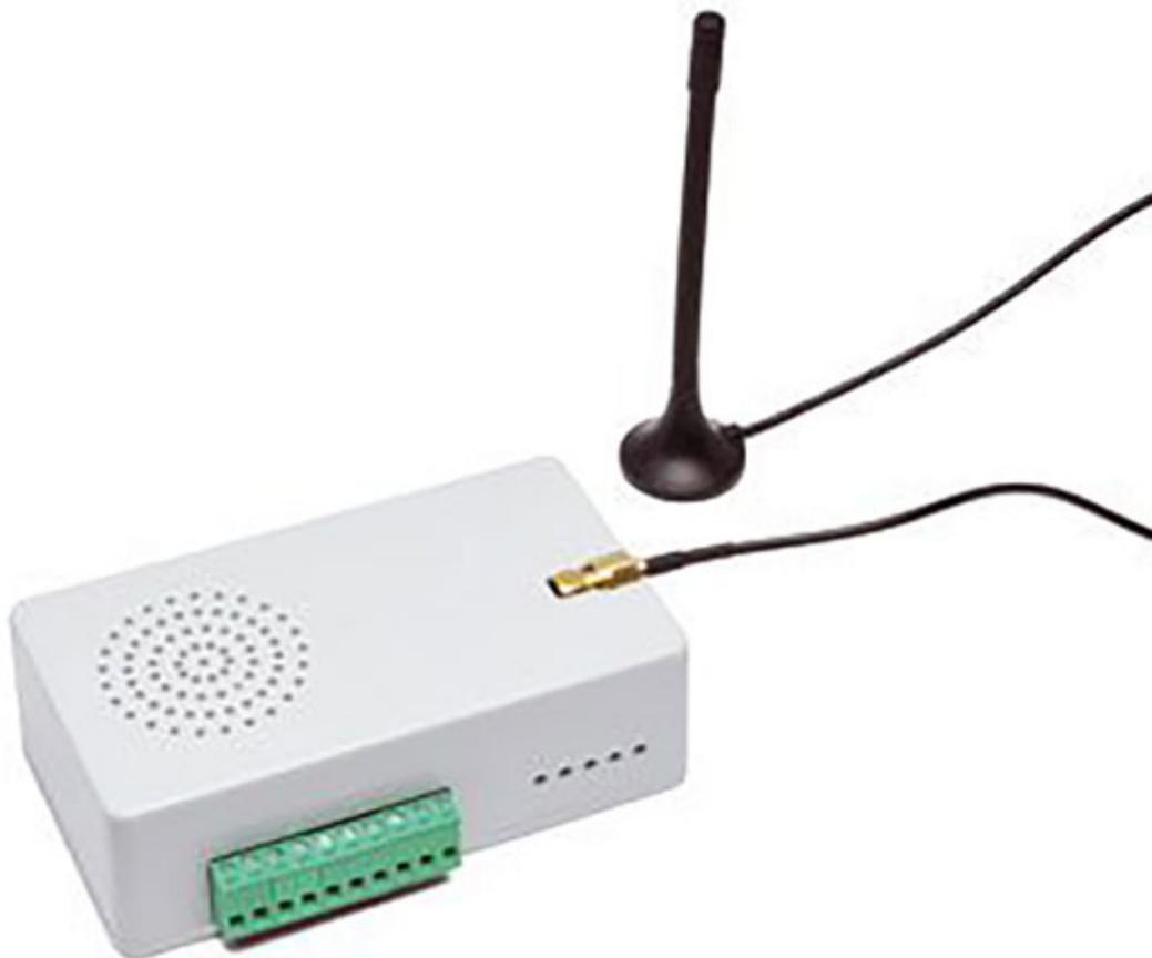
Contenitore in ABS appositamente forato per ospitare il combinatore telefonico GSM codice 8100-TDG135. Dispone di angoli arrotondati, pannello in plastica e superfici lucide. Dimensioni esterne (mm): 125 lunghezza x 70 larghezza x 39 altezza. N.B. il combinatore telefonico e l'antenna non sono compresi.
