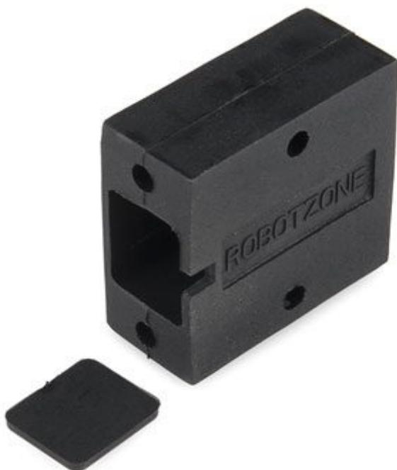
Realizzato appositamente per i micro motoriduttori in metallo della serie MMG, questo piccolo box consente di inserire direttamente il motoriduttore senza bisogno di fissarlo con viti. Dispone di una parte plastica che serve a bloccare la parte posteriore del motoriduttore, due fori sulla parte superiore e due nella parte anteriore che consentono di fissare il tutto alla superficie o all'oggetto che volete. Dimensioni (mm): 29x25,4x12,7.
