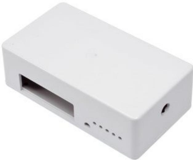
Contenitore in ABS appositamente forato per ospitare il telecomando GSM (programmato solo con bootloader e venduto senza sketch) 5100-FT924M. Dispone di angoli arrotondati, pannello in plastica e superfici lucide. Dimensioni esterne: 125 x 70 x 39h mm. Dimensioni interne: 120 x 63 mm. **N.B.** il telecomando e l'antenna non sono compresi.
