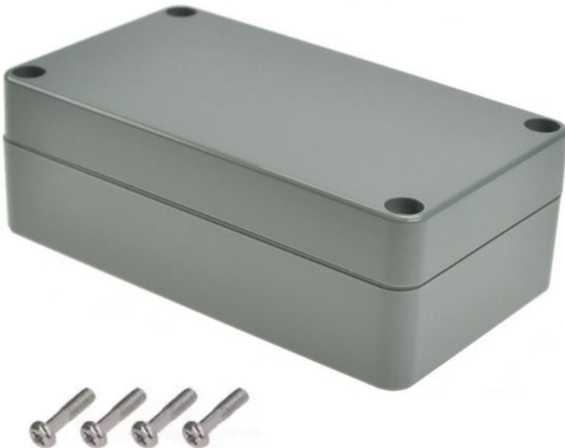
Ideale per strumentazione ed apparecchiature per telecomunicazioni, sia per dispositivi portatili che da laboratorio. Realizzato in ABS antiurto resistente al calore (da -20°C a +100°C) con grado di protezione all'acqua e alla polvere IP65/ NEMA4 conforme alla normativa IEC 529. Dispone di una chiusura a guscio con guarnizioni costituite in neoprene. Le scanalature e le sporgenze interne consentono di alloggiare circuiti stampati sia in posizione verticale che orizzontale.
