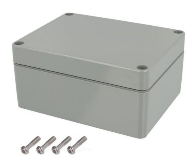
Ideale per strumentazione ed apparecchiature per telecomunicazioni, sia per dispositivi portatili che da laboratorio. Realizzato in ABS antiurto resistente al calore (da -20°C a +100°C) con grado di protezione all'acqua e alla polvere IP65/ NEMA4 conforme alla normativa IEC 529 . Dispone di una chiusura a guscio con guarnizioni costituite in neoprene. Le scanalature e le sporgenze interne consentono di alloggiare circuiti stampati sia in posizione verticale che orizzontale.
