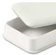
Contenitori stampati in bicomponente (ABS/PC e TPU). Nel fondo sono presenti punti di fissaggio per PCB. Chiusura a scatto. Ideale per strumentazione ed apparecchiature per telecomunicazioni, sia per dispositivi portatili che da laboratorio. Dimensioni: 80x56x22 mm. Colore: grigio chiaro.
