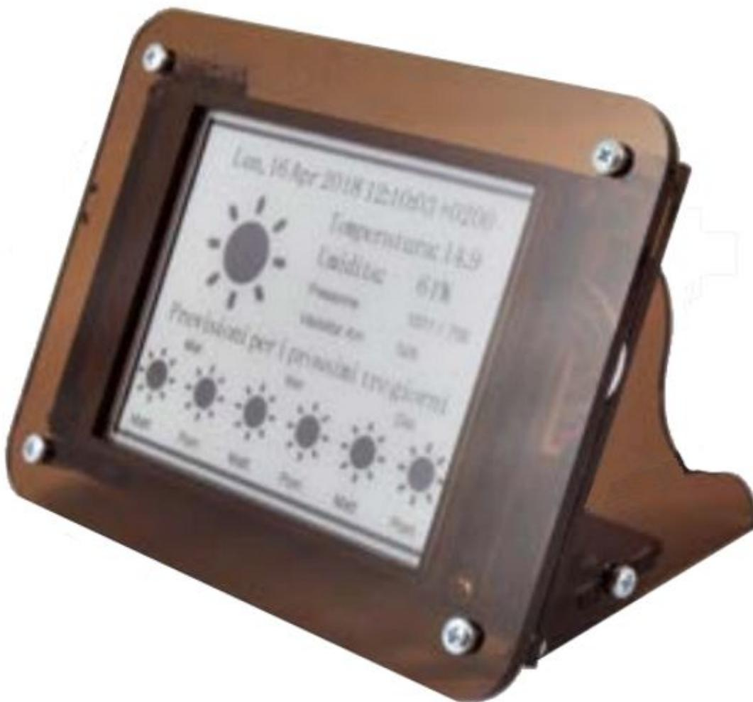
Contenitore in plexiglass realizzato con taglio laser, da utilizzare per il progetto "Stazione meteo con ePAPER" presentato sul numero 226 di Elettronica In **Attenzione** ! il prezzo è riferito al solo Case. Le parti elettroniche sono da acquistare separatamente (vedere prodotti correlati).
