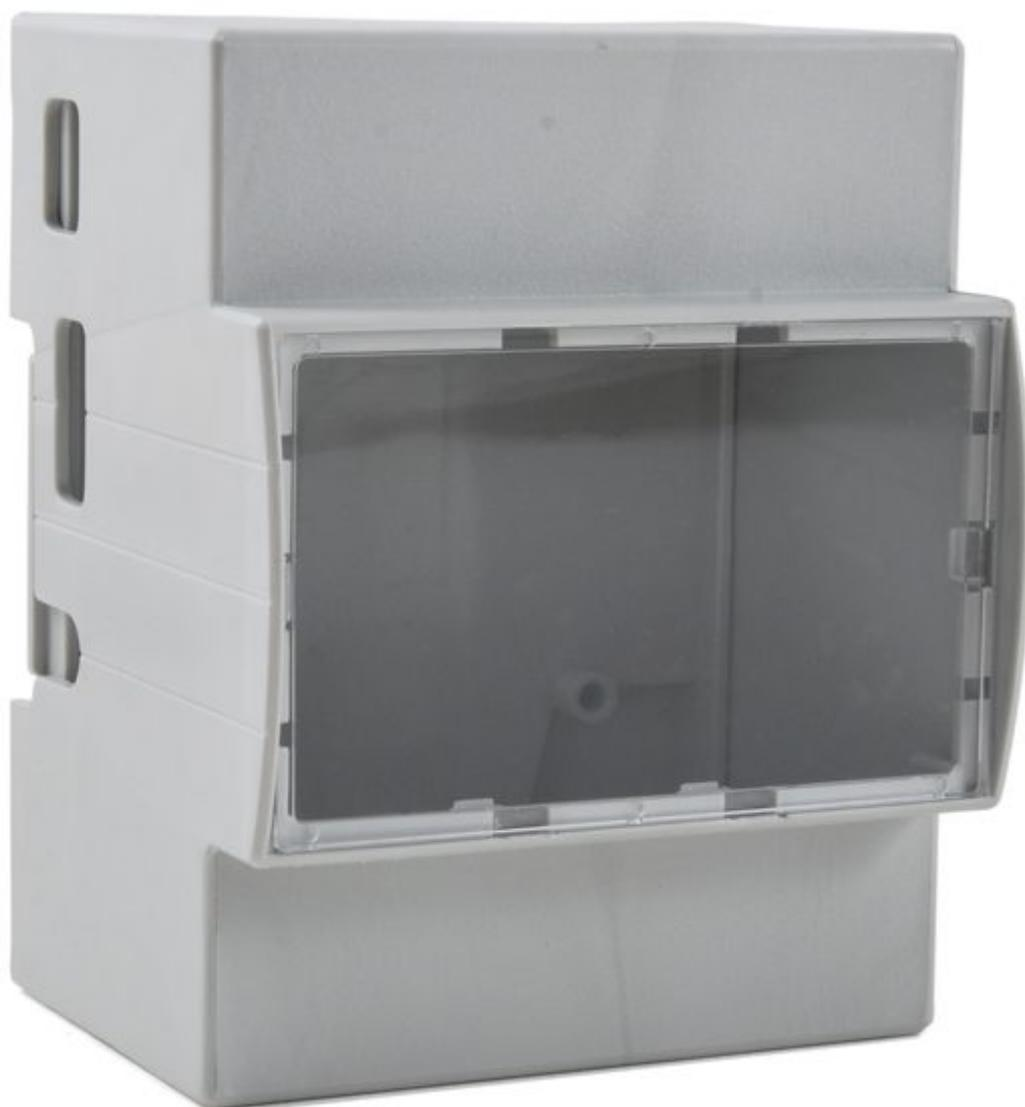
Contenitore plastico da montare su una guida DIN, con finestra trasparente e appositamente forato per ospitare il prodotto Raspberry PI B+ / 3B e 3B+. Dimensioni esterne (mm): 90,5x71,3x62 (4 moduli DIN). **N.B.** il prodotto Raspberry PI non è compreso.
