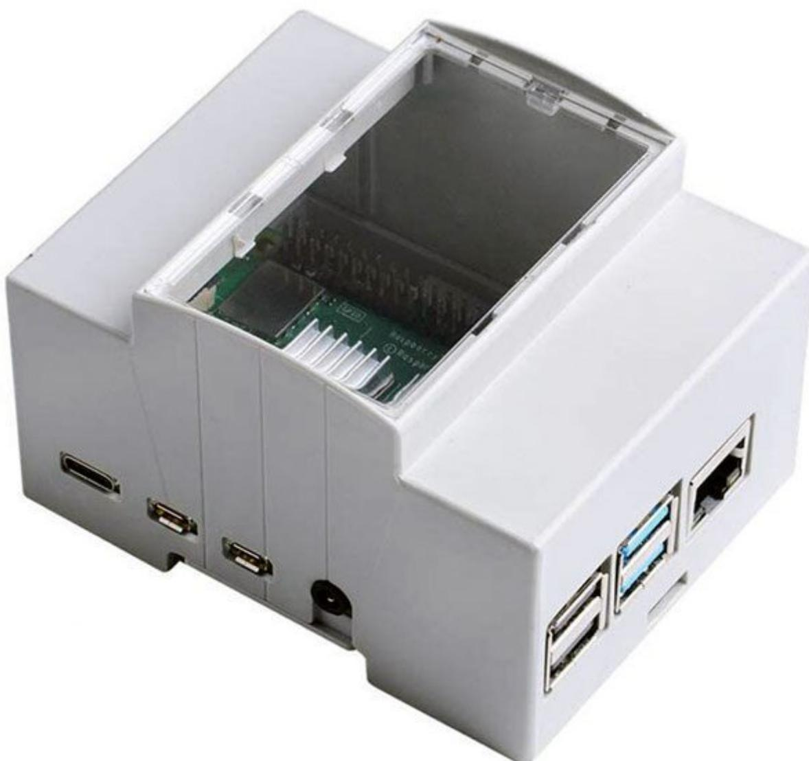
Contenitore plastico da montare su una guida DIN, con finestra trasparente e appositamente forato per ospitare il prodotto Raspberry Pi 4. Dimensioni esterne (mm): 90,5x71,3x62 (4 moduli DIN). **N.B.** il prodotto Raspberry Pi 4 non è compreso (vedere prodotti correlati).
