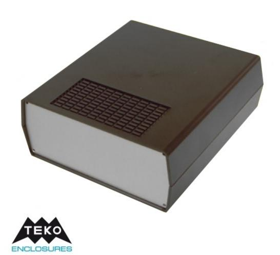
Contenitore in PSA con due pannelli di alluminio fissati con 4 viti e fessure di areazione. Superfici opache. Dimensioni: fronte 178 x 72h; profondità 198 mm.
