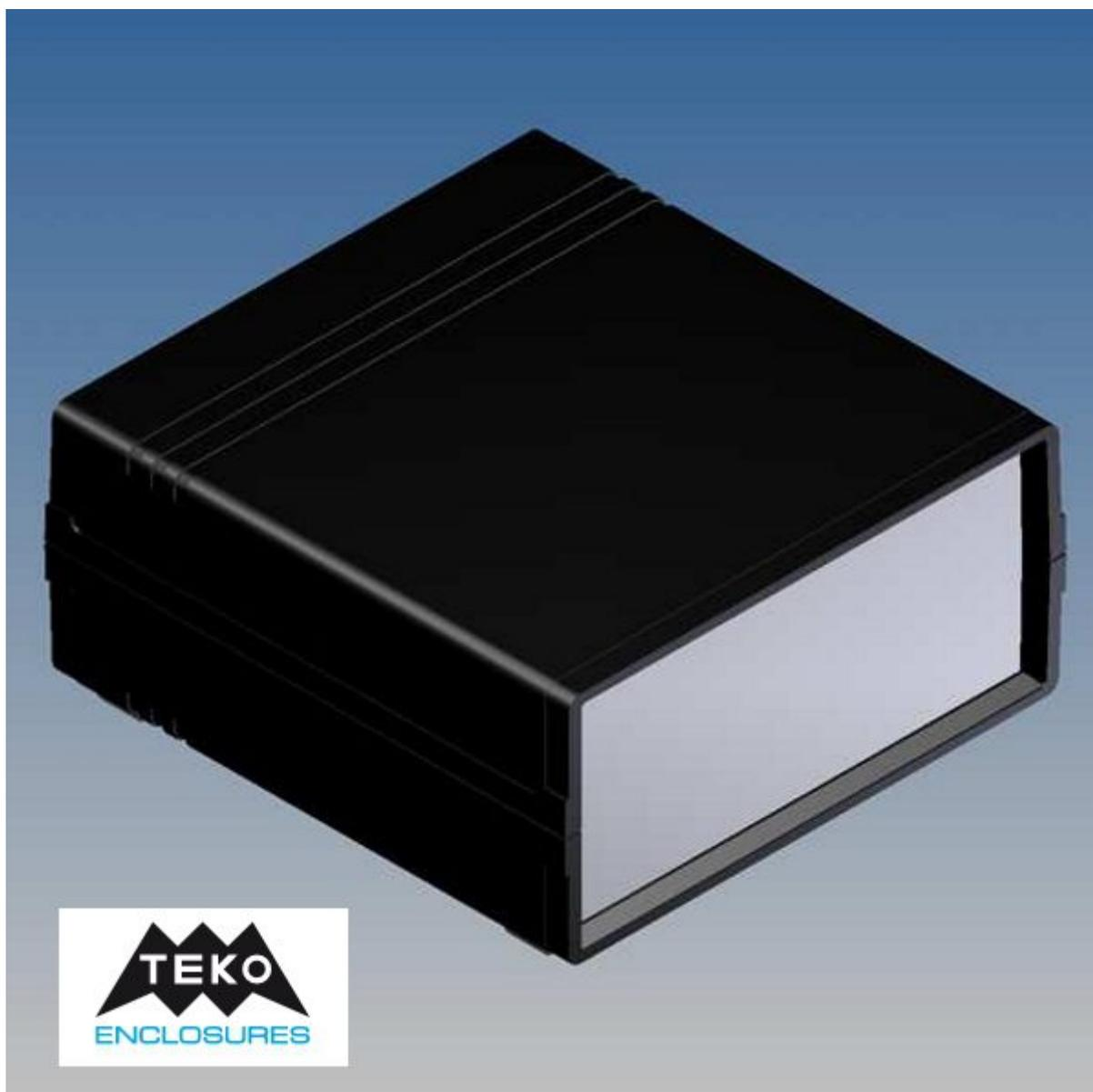
Contenitore in ABS con superfici opache e provvisto di due pannelli frontali in alluminio di 1mm di spessore. All'interno sono presenti guide e punti di fissaggio per PCB. Dimensioni: fronte 129 x 54h mm; profondità 134 mm.
