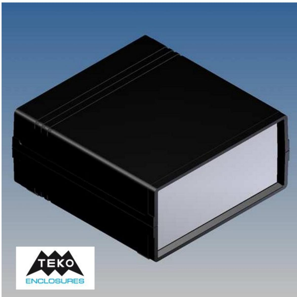
Contenitore in ABS con superfici opache e provvisto di due pannelli frontali in alluminio di 1mm di spessore. All'interno sono presenti guide e punti di fissaggio per PCB. Dimensioni: fronte 129 x 61h mm; profondità 134 mm.
