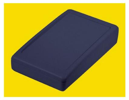
Contenitore Teko plastico nero. Materiale: polistirolo antiurto con superfici opache. La parte superiore ha un'area ribassata per l'alloggiamento di una tastiera a membrana. All'interno sono presenti dei punti di fissaggio per PCB. Chiusura a 4 viti, coperchio inclinato (codice Teko SM2S.9). Dimensioni 160x95x35,5 mm.
