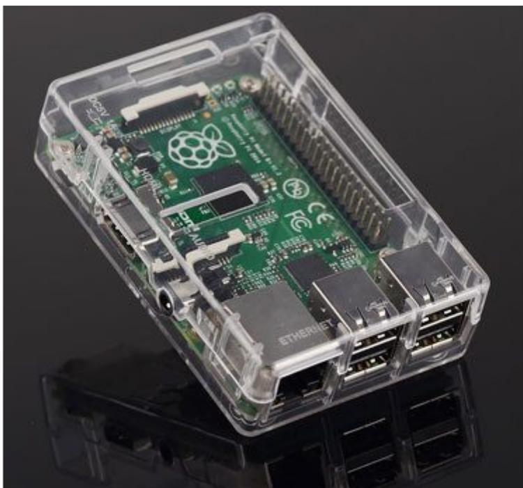
Contenitore plastico trasparente appositamente realizzato e forato per ospitare il prodotto [Raspberry Pi](#) 2 modello B, Raspberry Pi modello B+ e Raspberry Pi 3. Si assembla semplicemente incastrando le due metà. Dimensioni esterne (mm): 92 (lunghezza) x 62,50 (larghezza) x 26,70 (altezza) mm, dimensioni interne (mm): 86 (lunghezza) x 57 (larghezza) x 26 (altezza). Comprende anche 4 viti per il fissaggio di Raspberry e 4 piedini adesivi. **N.B.** il prodotto Raspberry PI non è compreso.
