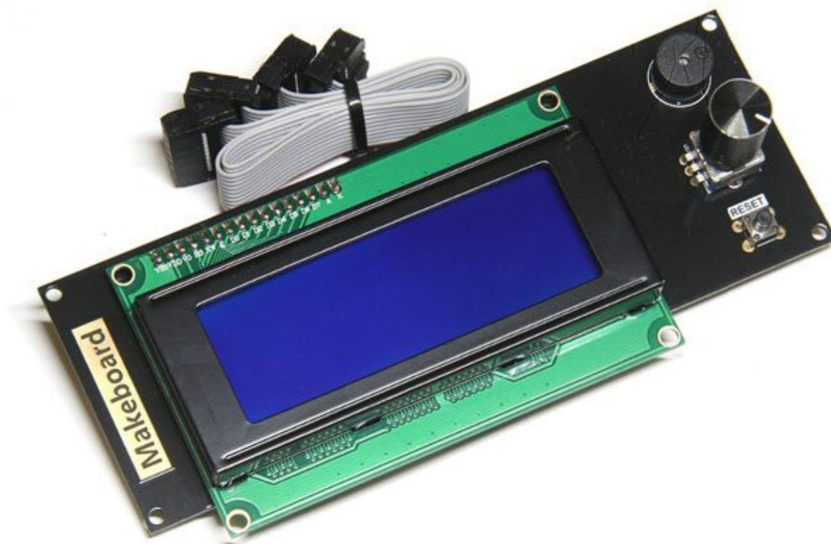
Dotata di encoder rotativo, display 4 righe 20 caratteri retroilluminato scritte bianche su sfondo blu, slot per schede SD card e pulsante di reset, questa scheda permette di controllare la stampante
