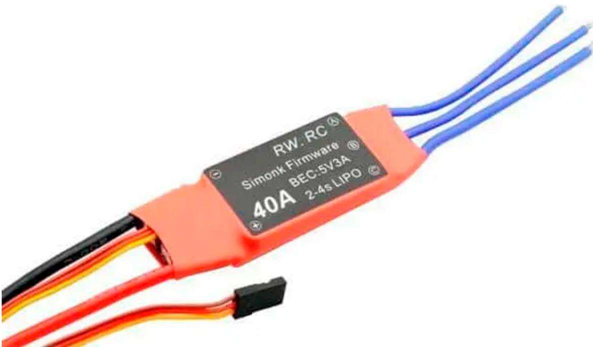
Dotato di firmware SimonK, questo controller di velocità da 40 Amper per motori brushless è particolarmente indicato per multicotteri, aeromobili ad ala fissa ed elicotteri. Alimentazione: 2-4 lipo (da 7,4 a 14,8 V) - BEC output: 5V / 3A - corrente di funzionamento: 40 A (uscita: 40 A continui, 50 A max. per 10 secondi), frequenza del segnale: da 30 Hz a 500 Hz. Dimensioni (mm): 68x26x9, peso: 30 grammi.
