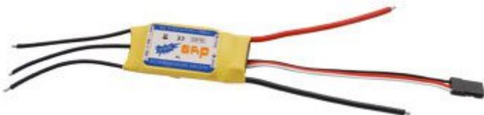
Controller di velocità per motori brushless. Alimentazione: da 5 V a 12 V, corrente: 18 A per 10 minuti, numero di batterie: 4-12 NiMH, 2-3 LiPO - uscita BEC: 5 V - 1,5 A - 2 LiPO 4-5 mini servo, 3 LiPO 3-4 mini servo. Utilizzato nel progetto "RASAERBA AUTOMATICO A ENERGIA SOLARE" pubblicato sul numero 139 della rivista Elettronica In ~ Luglio / Agosto 2009.
