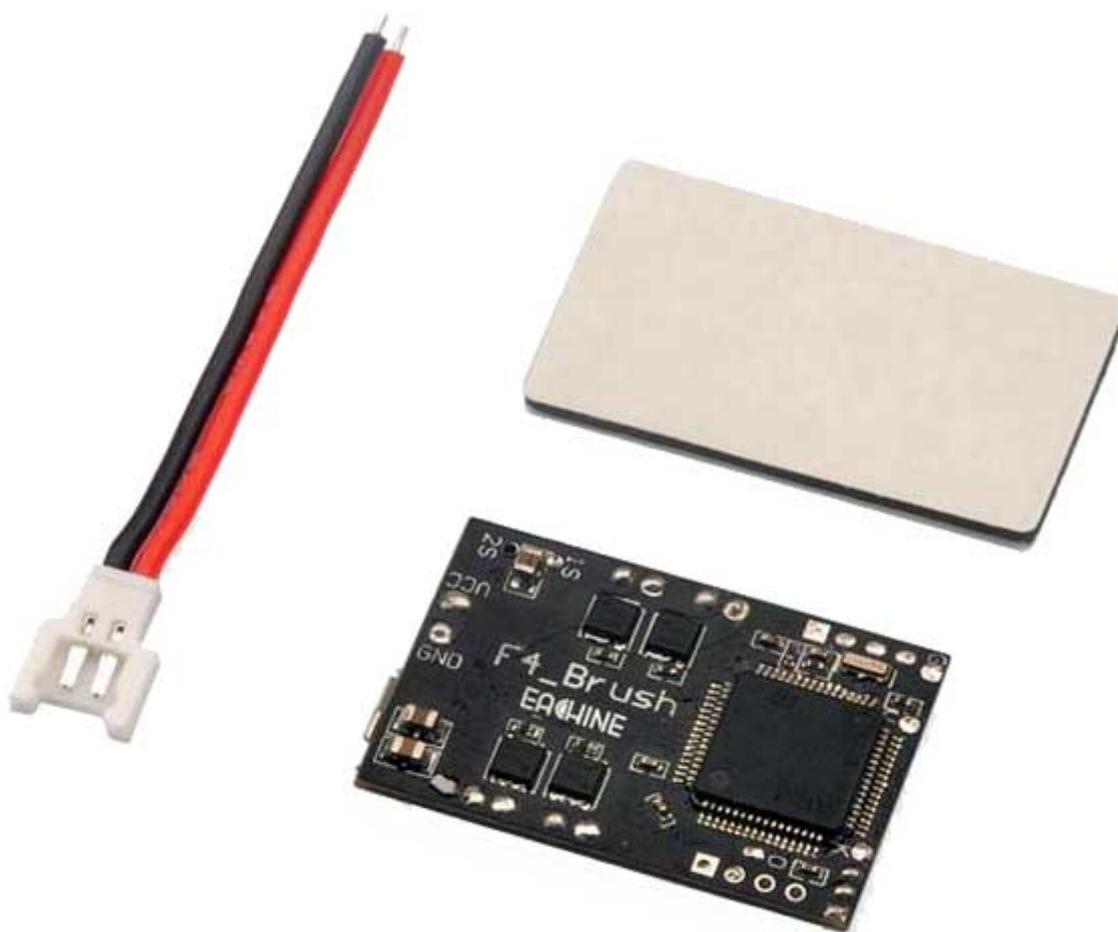
Controller di volo dotato di chip STM32F405 ARM Cortex M4 con una frequenza di funzionamento di 168 MHz. Basato sulla piattaforma Openpilot CC3D Revolution (Revo), supporta ricevitori SBUS / DSM / DSM2 / DSMX, può essere alimentato con una batteria LiPo 1S o 2S (selezionabile tramite deviatore). Dimensioni (mm): 32,5x22x1,2, peso: 4 grammi.
