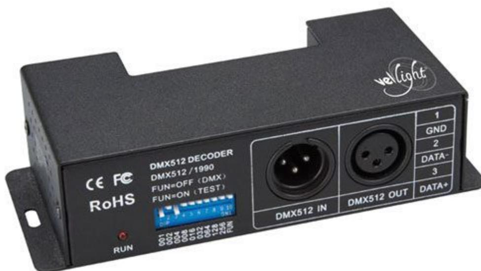
Controller DMX per strip a LED in grado di gestire fino a 4 canali (Red - Green - Blue - White) con una corrente massima di 6 A. Funzionamento automatico e tramite DMX, selezionabile tramite DIP switch, alimentazione: 12 o 24 Vdc.
