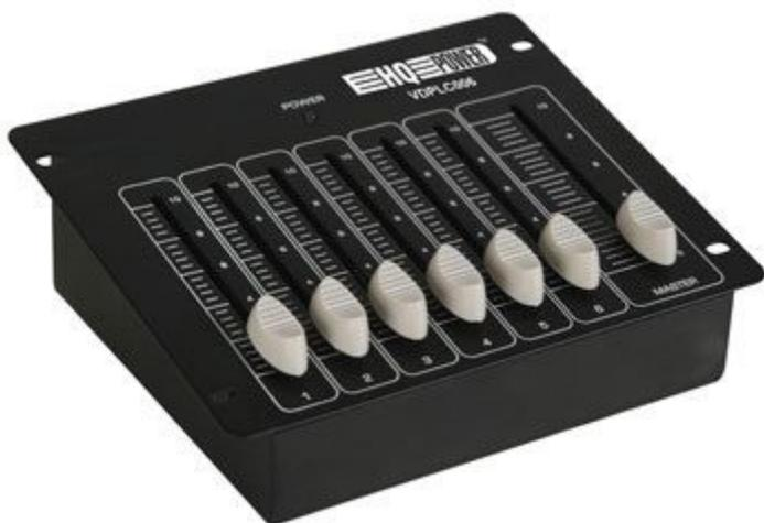
Controller DMX per impianto luci dotato di 6 slider più 1 master, interruttore on/off e connettore di uscita DMX: XLR 3 pin. Gli slider da 1 a 6 consentono di modificare gli effetti del canale corrispondente, mentre lo slider master fornisce un controllo generale dell'uscita DMX impostata dagli slider da 1 a 6. Alimentabile tramite alimentatore da rete: 220 Vac - 9 Vdc/200 mA (incluso) e tramite batteria 9 Vdc (non inclusa). Dimensioni: 173 x 153 x 55 mm, peso: 0,8 kg.
