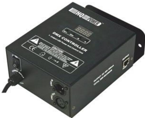
Controller DMX che permette di gestire e alimentare fino a 12 lampade RGB codice 8220-LEDA03. Modalità di funzionamento automatica, a controllo musicale, DMX o master / slave. Dispone 6 programmi preimpostati e 18 colori. Controllabile anche tramite telecomando codice 8220-LEDA03RC disponibile separatamente. Alimentazione 230 Vac; dimensioni 125 x 70 x 194 mm.
