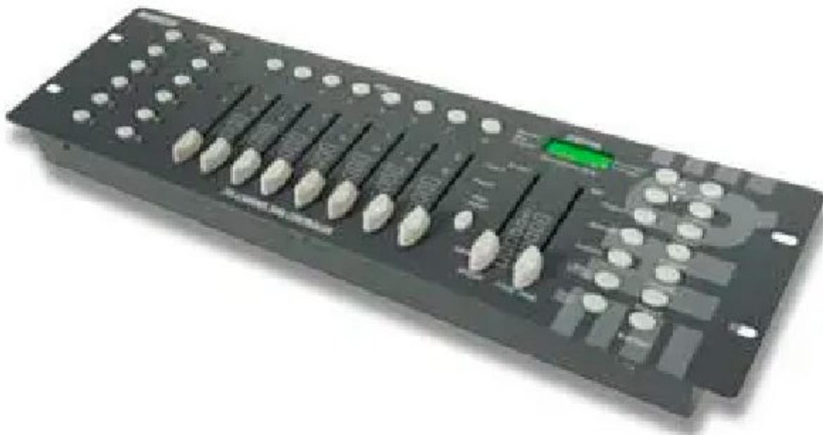
Controller luci standard DMX512 in grado di generare segnali di controllo per 192 canali. Possibilità di memorizzare scene e sequenze programmabili. Dispone di otto slider per il controllo dei livelli. Altri due slider controllano il tempo e la velocità di fade. Controlla 12 scanner da 16 canali ciascuno. Ingresso microfonico e MIDI. Contenitore tipo Rack 19".
