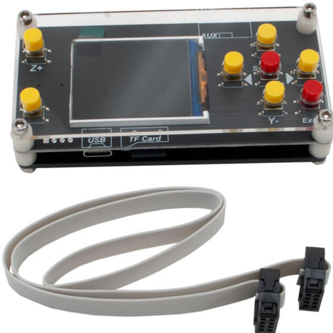
Scheda dotata di un proprio microcontrollore, un piccolo display LCD ed alcuni pulsanti. Abbinata al controller GRBLCONTROLLER (vedi prodotti correlati), permette di lavorare con una piccola CNC senza dover necessariamente disporre di un PC, essendo necessario solo il file generato dal software CAM e caricato su una micro SD card.
