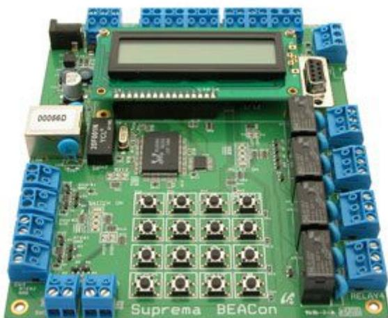
BEACon™ è un controller che permette di realizzare un sistema di controllo accessi stand alone (senza l'ausilio del PC). Può gestire due BioEntry Pass contemporaneamente. Dispone di quattro uscite a relè, sei ingressi per interruttori, interfaccia RS232, RS485, TCP/IP, una tastiera a sedici pulsanti e un display a 16 caratteri x 2 righe. BEACon è la soluzione ideale per realizzare un sistema di controllo accessi semplice e poco costoso.
