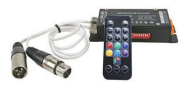
Controller adatto per gestire strip a LED singolo colore, RGB o RGB+BIANCO (CHLS16RGBW). Può essere gestito tramite il telecomando IR in dotazione, tramite DMX o in automatico tramite impostazione dip switches. Dispone di 14 differenti effetti preimpostati e 4 linee d'uscita per il collegamento strip a LED, potenza massima su ciascun linea 60 W (12 Vdc) o 120 W (24 Vdc). Portata telecomando IR 7 metri.
