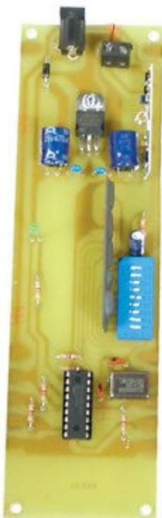
Unitamente ai display giganti FT427DK, consente di realizzare un contatore ed un segnapunti il cui avanzamento viene controllato tramite un comune radiocomando a due canali. Il segnapunti potrà essere utilizzato negli incontri di pallacanestro, pallanuoto, rugby, ed in molte altre discipline sportive.
