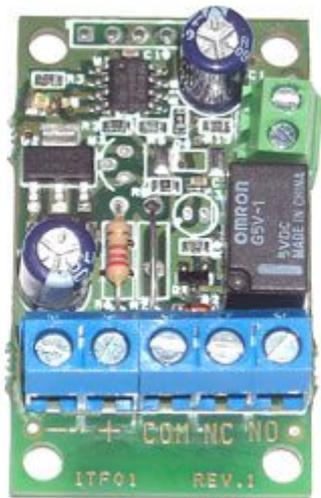
Interfaccia di controllo e segnalazione batteria scarica per la fotocellula FR443. Quando il livello di tensione della batteria scende sotto una soglia prestabilita, il relè di uscita si attiva. Alimentazione: 12 Vcc/24 Vac Uscita open-collector. Dimensioni: 46 mm (lunghezza) x 27 mm (larghezza).
